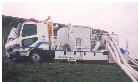
写真 4.3.1 排水ポンプ車
