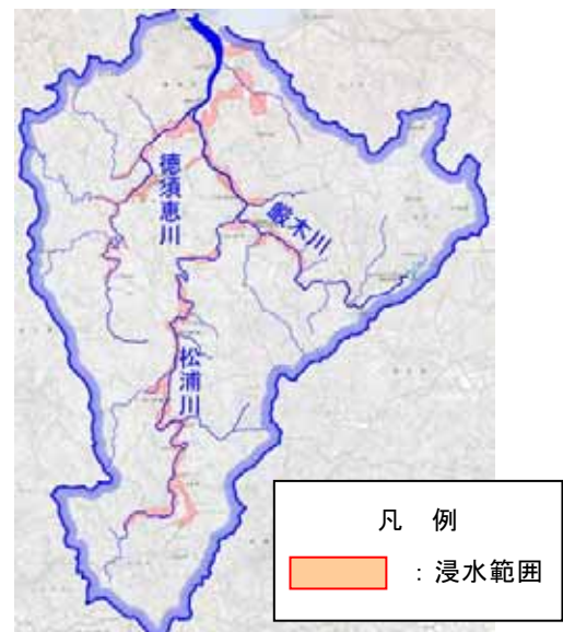
図 1.2.1 平成2年7月洪水浸水状況図 梅雨前線豪雨により、越水など各所で発生し、深刻な被害を受けました。松浦川本川、支川徳須恵川、支川巖木川の3河川で、越水被害延長 25,700m、越水被害額 60億円にのぼる大出水となりました。
