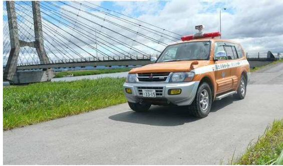
パトロールカーは出水時や災害時にも使用され、緊急走行のための赤色警告灯、緊急連絡のための無線装置等を装備しています
