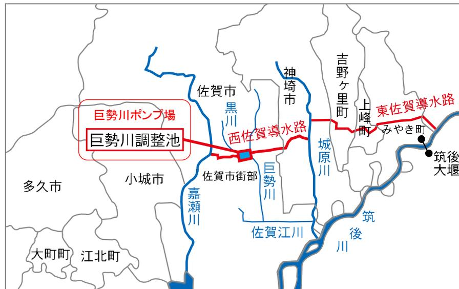
※巨勢川調整池：「巨勢川の洪水被害、周辺の内水被害を軽減するための施設」
