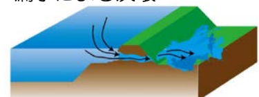
漏水による決壊
