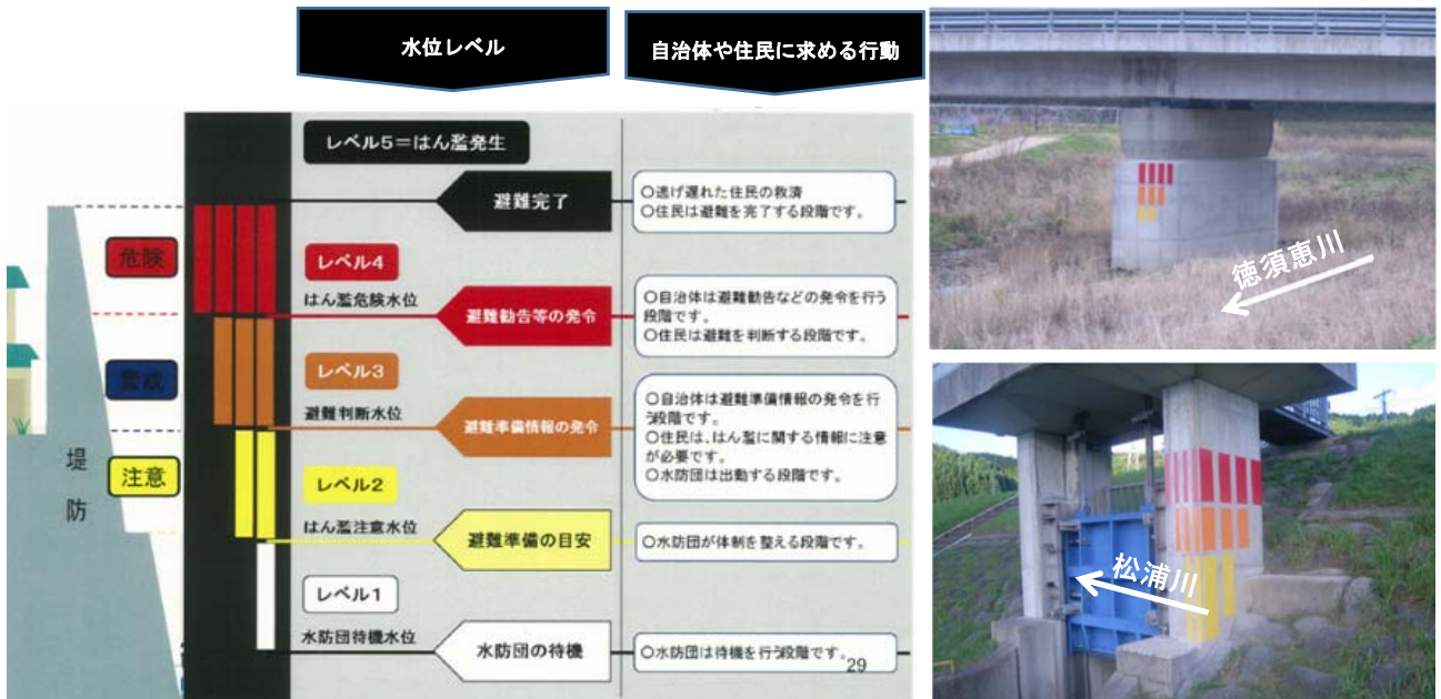
水位レベル表示(量水標)の設置
