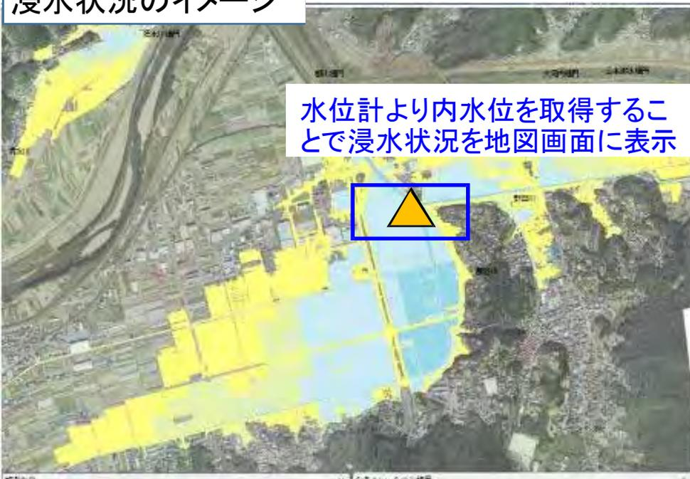
水位計より内水位を取得することで浸水状況を地図画面に表示
