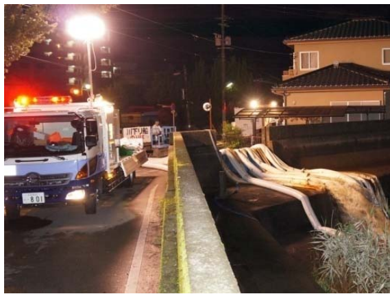
排水ポンプ車による排水
