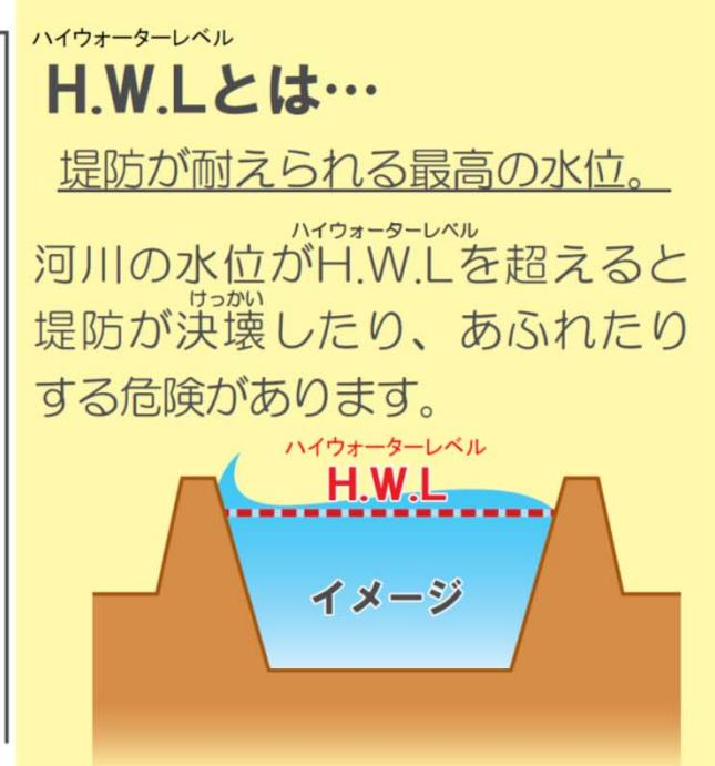
河川の水位が、堤防が耐えられる最高の水位（H.W.L.）を超えた際、ポンプで田畠や家屋側の水（内水）を排水し続けると、堤防が決壊したり、堤防から越水したりして、六角川・牛津川の河川の水（外水）が家屋側に氾濫し、広い範囲で被害が発生する可能性があります。このような場合、ポンプの運転調整を行います。
