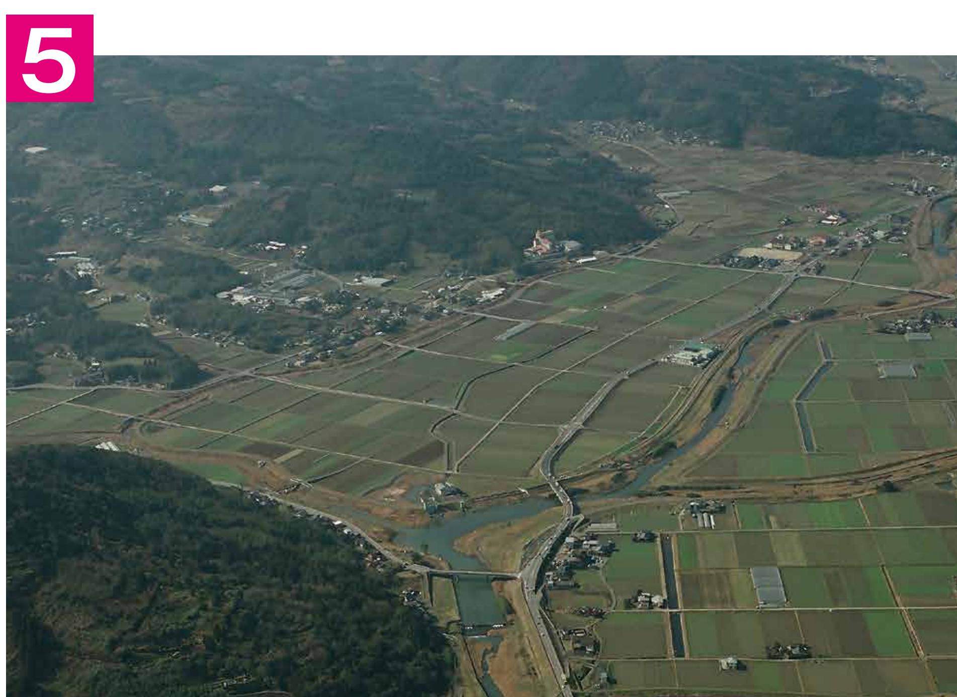
5 遊水地 ゆう すい ち 【面積52.4ヘクタール・遊水量約90万m 3 】 大洪水のときには、この区域に一時的に水を貯め、下流の被害を減らします。
