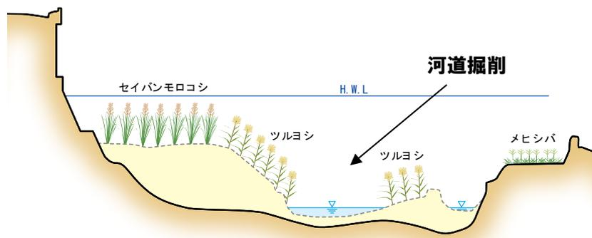
図 5.1.4 河道掘削（牛津川中上流）
