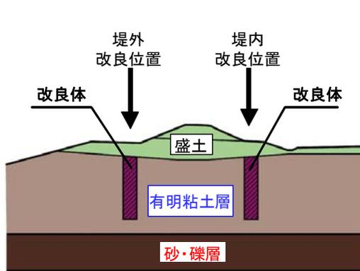
図 1.2.10 軟弱地盤上の築堤イメージ
