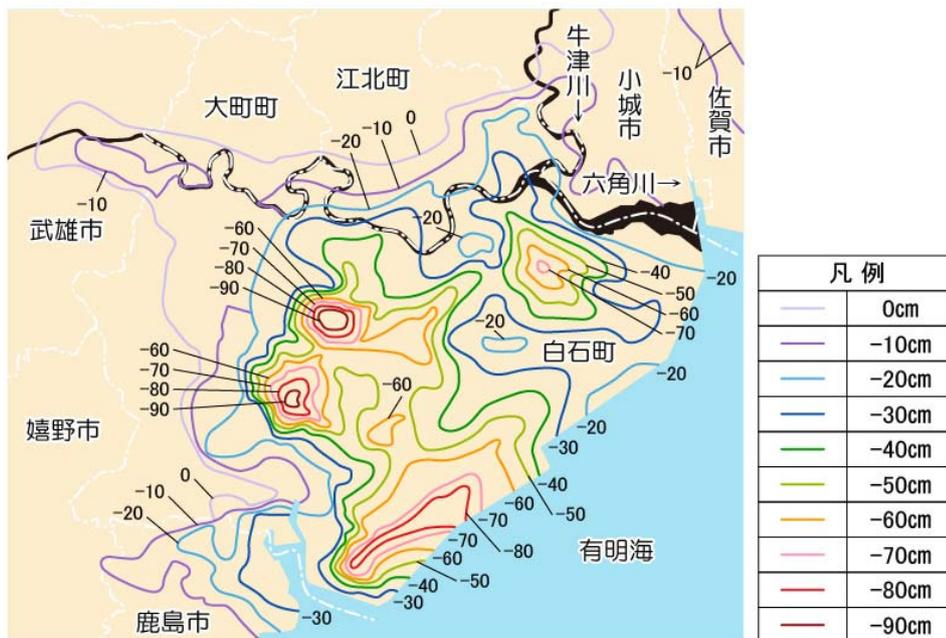
図 2.2.4 地盤沈下累積等量線図
