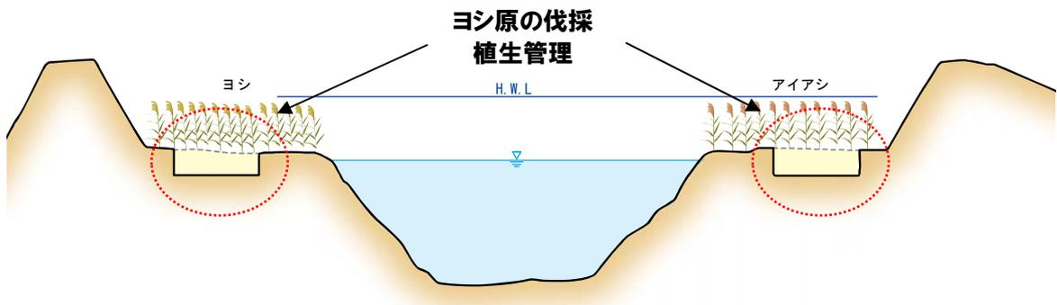
図 5.1.3 河道掘削（牛津川下流）
