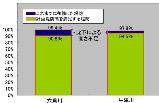
図 2.1.2 堤防の沈下状況（平成30年度時点）
