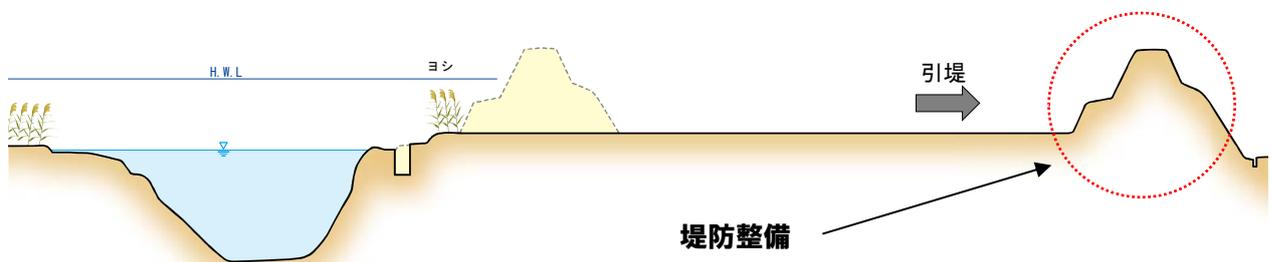
図 5.1.1 築堤、引堤（牛津川）
