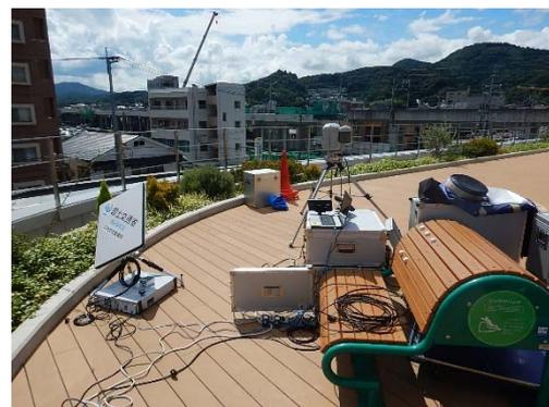
写真 2.1.17 衛星通信可搬局装置
