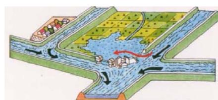
③大きな洪水の時は、洪水の一部を越流堤から計画的に遊水地に導き、一時的に貯留し、下流河川の流量を低減させる
