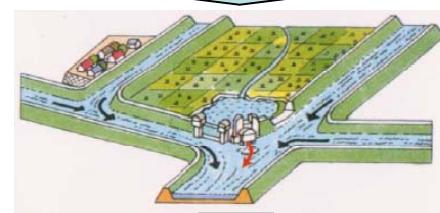
②河川を流れる洪水が遊水地の越流堤を越えない程度の中小洪水の時は、遊水地内の水をポンプで吐き出し、浸水させない。(洪水調節を開始するまでは遊水地の容量を最大限確保する。)
