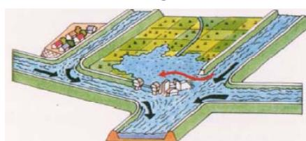
③大きな洪水の時は、洪水の一部を越流堤から計画的に遊水地に導き、一時的に貯留し、下流河川の流量を低減させる
