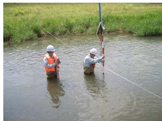
写真 河川の流量観測(低水流量)
