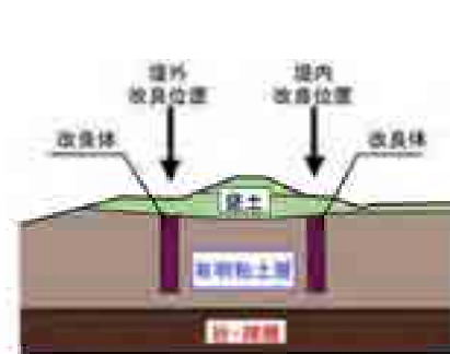
図 1.2.9 軟弱地盤上の築堤イメージ
