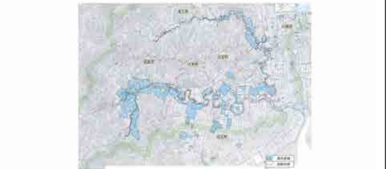
図1.2.4 浸水区域図（平成21年7月洪水、市別聞き取り調査、および武雄河川事務所内水痕跡調査による）
