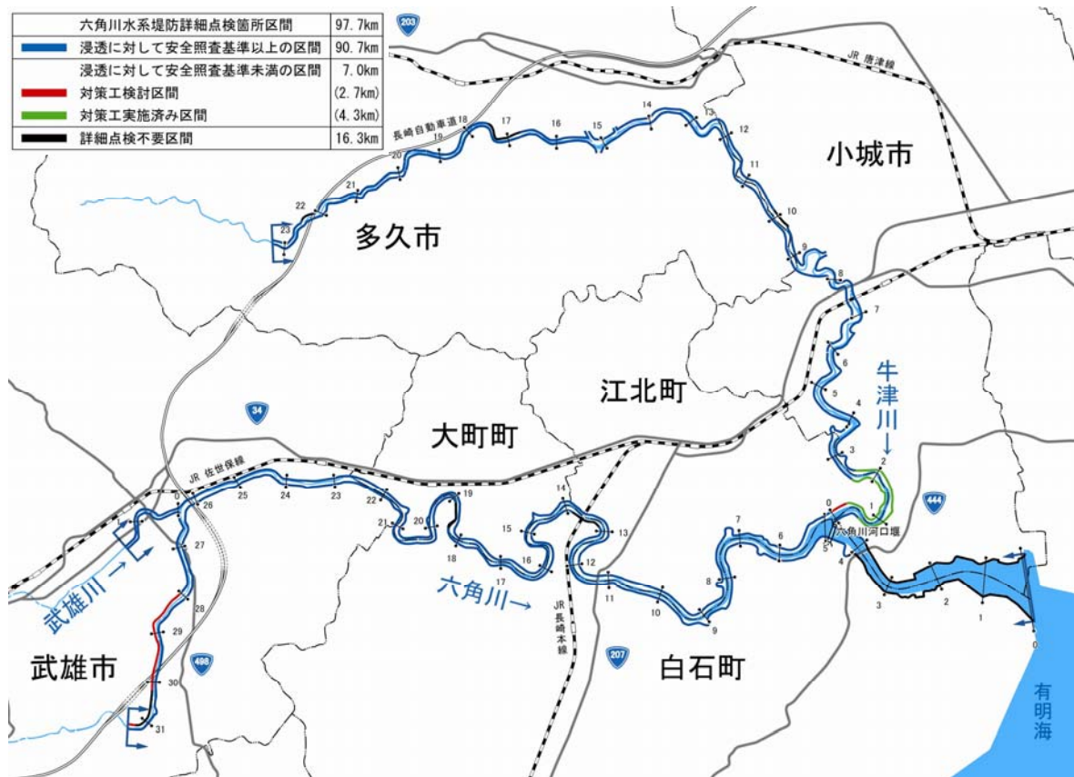
図2.1.5 六角川水系堤防詳細点検結果－国管理区間－
