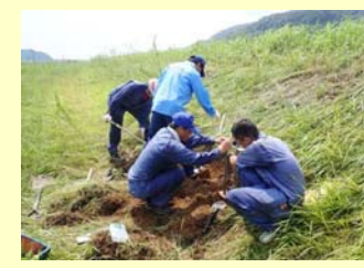
図 引張り破壊試験 実施状況
