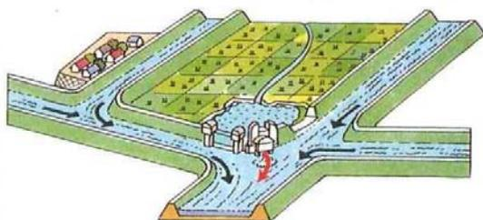
牛津川が大きな洪水となったときには、洪水の一部を越流堤から計画的に遊水地内に導き、一時的に貯留し、牛津川下流域の洪水被害を減らします。
