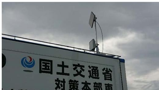
写真 2.1.20 5 GHz 帯無線アクセスシステム
