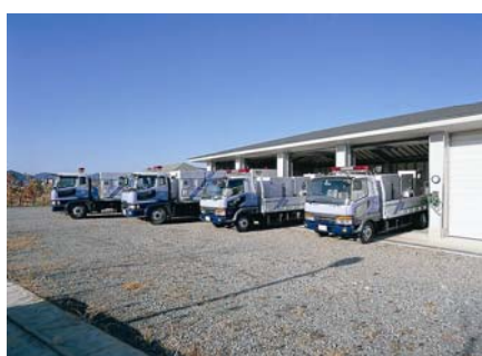
写真 2.1.13 排水ポンプ車
