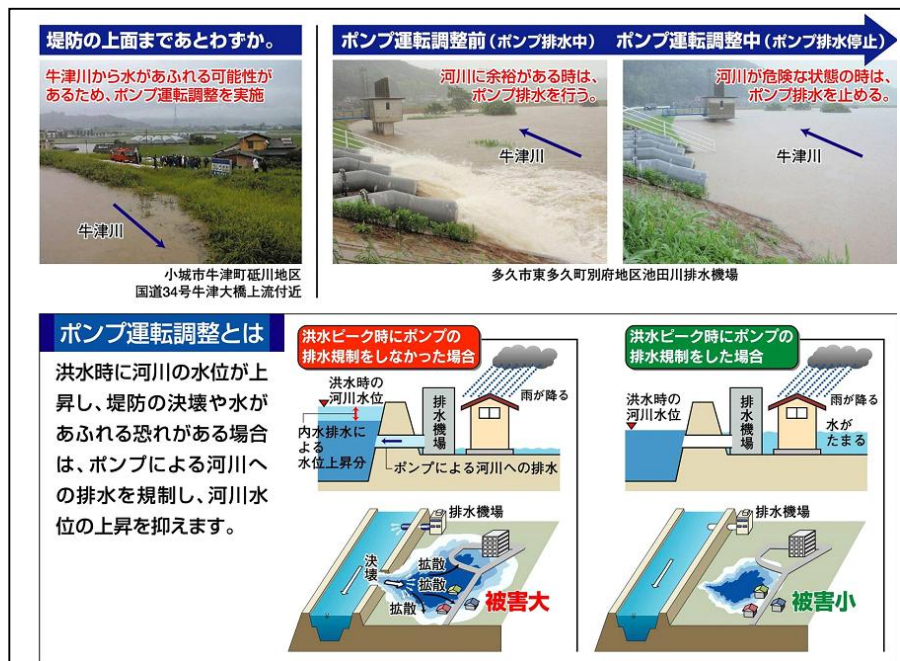
図 2.1.7 牛津川におけるポンプ運転調整（平成 21 年 7 月 26 日）
