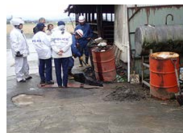
腐食したドラム缶から油流出
