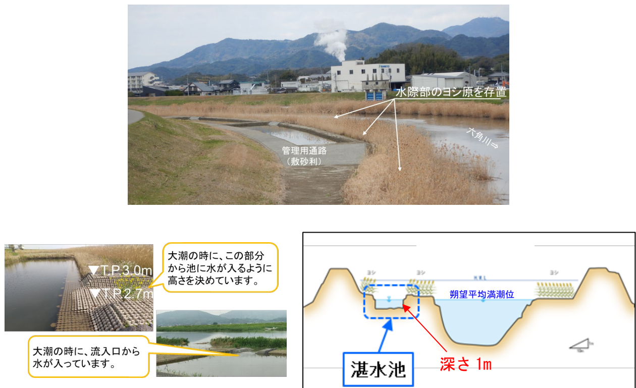
図-1.21 ヨシ繁茂抑制対策の概要
