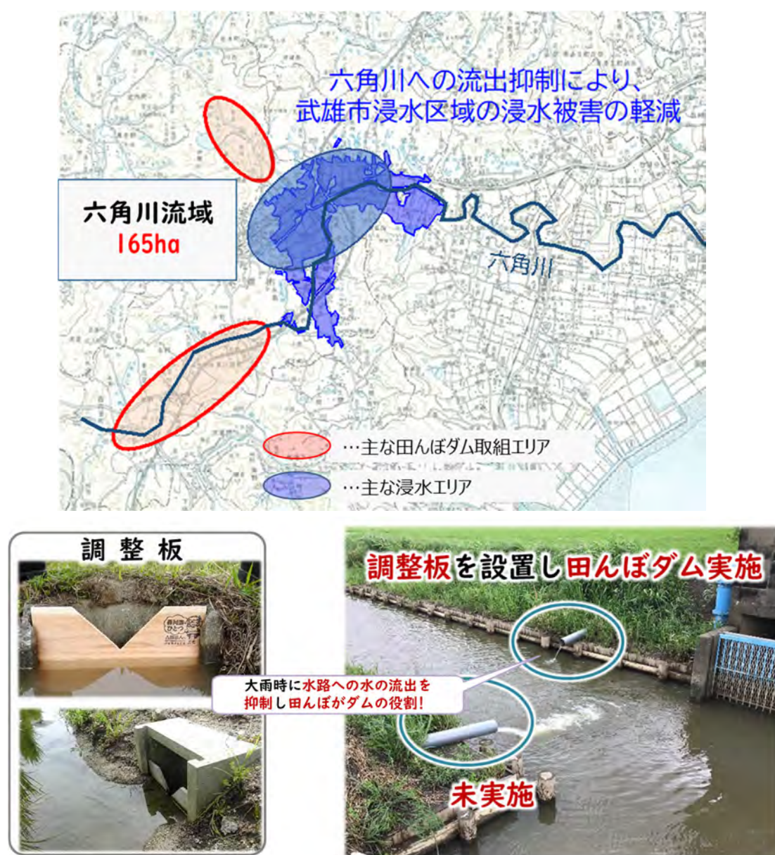
図-7.4 水田貯留の取組状況とイメージ図
