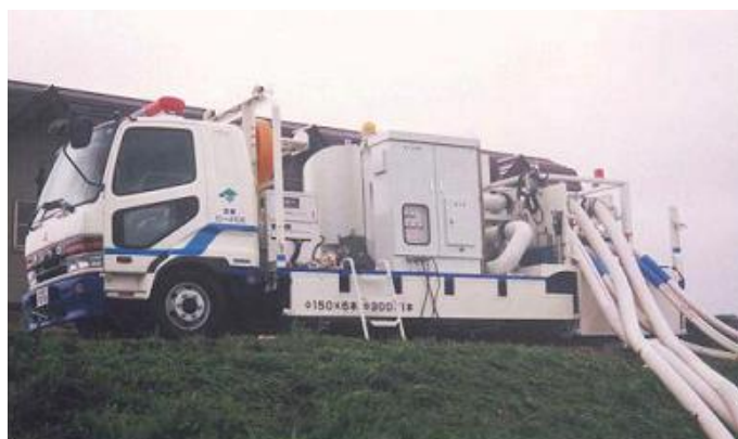
写真 4-3-1 排水ポンプ車
