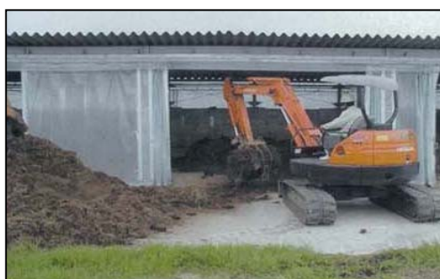
写真 4-3-9 除草工事の刈草を堆肥化
