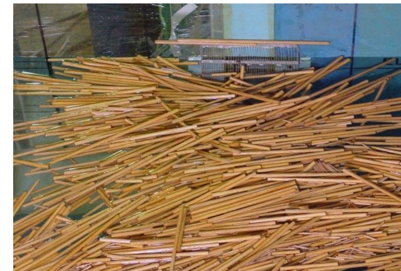
写真-6.2.1 流木の投入状況
