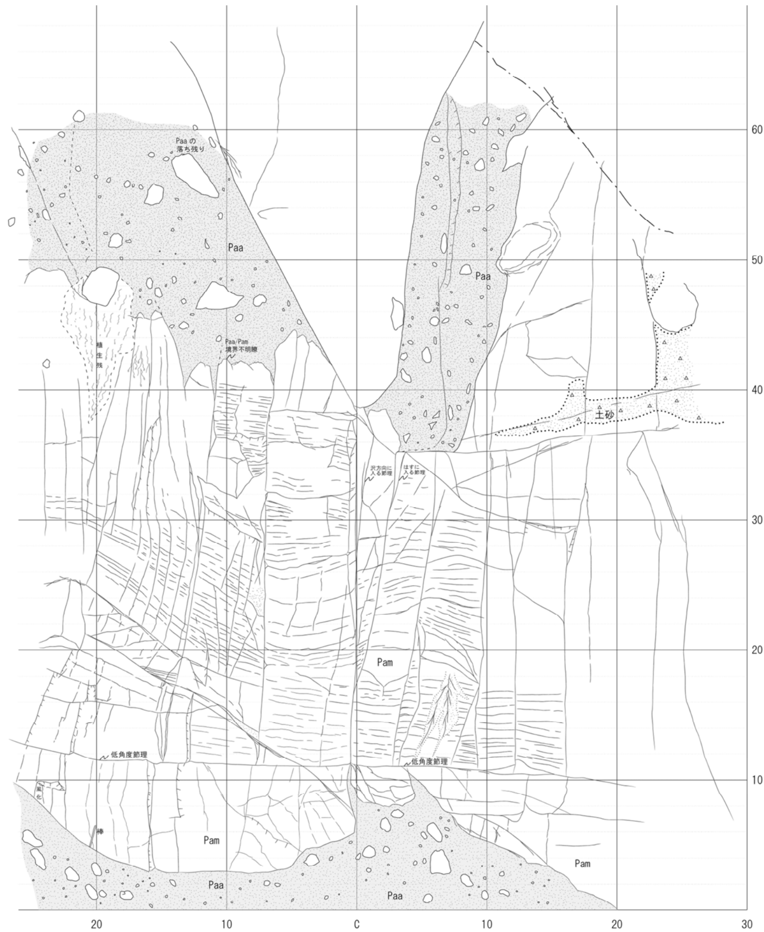
図-4.2.15 文献断層 25 延長部の岩盤露頭スケッチ
