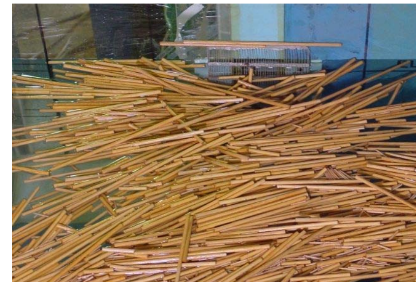
写真-6.2.1 流木の投入状況
