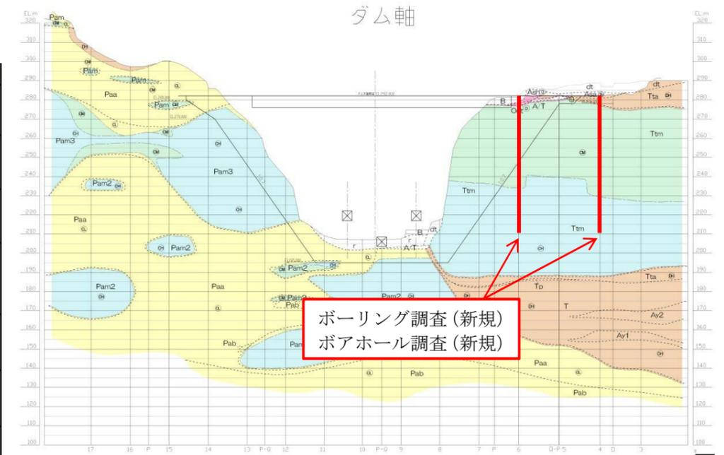
図-4.3.1 ボーリング調査断面図
