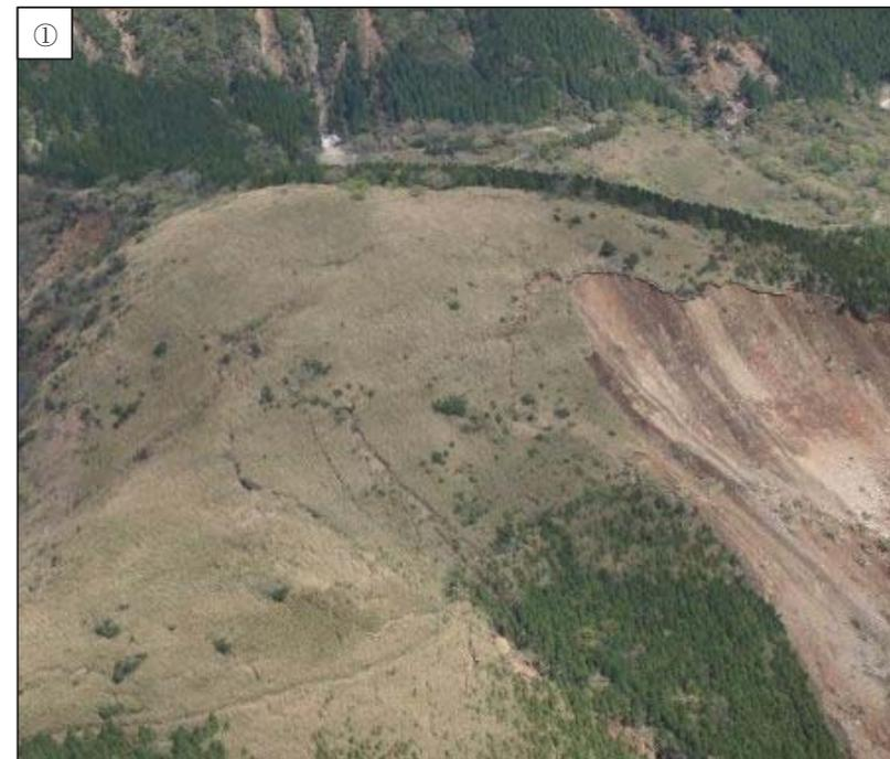
写真-5.4.2 斜面崩壊上部の亀裂状況（阿蘇大橋付近）
