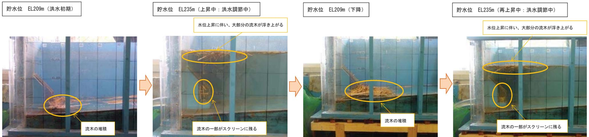
※水理模型実験は、上流に流木等捕捉施設を設置していない状態で実施。
