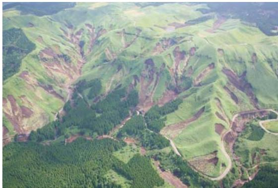
写真-5.1.1 斜面崩壊状況 (H24九州北部豪雨)
