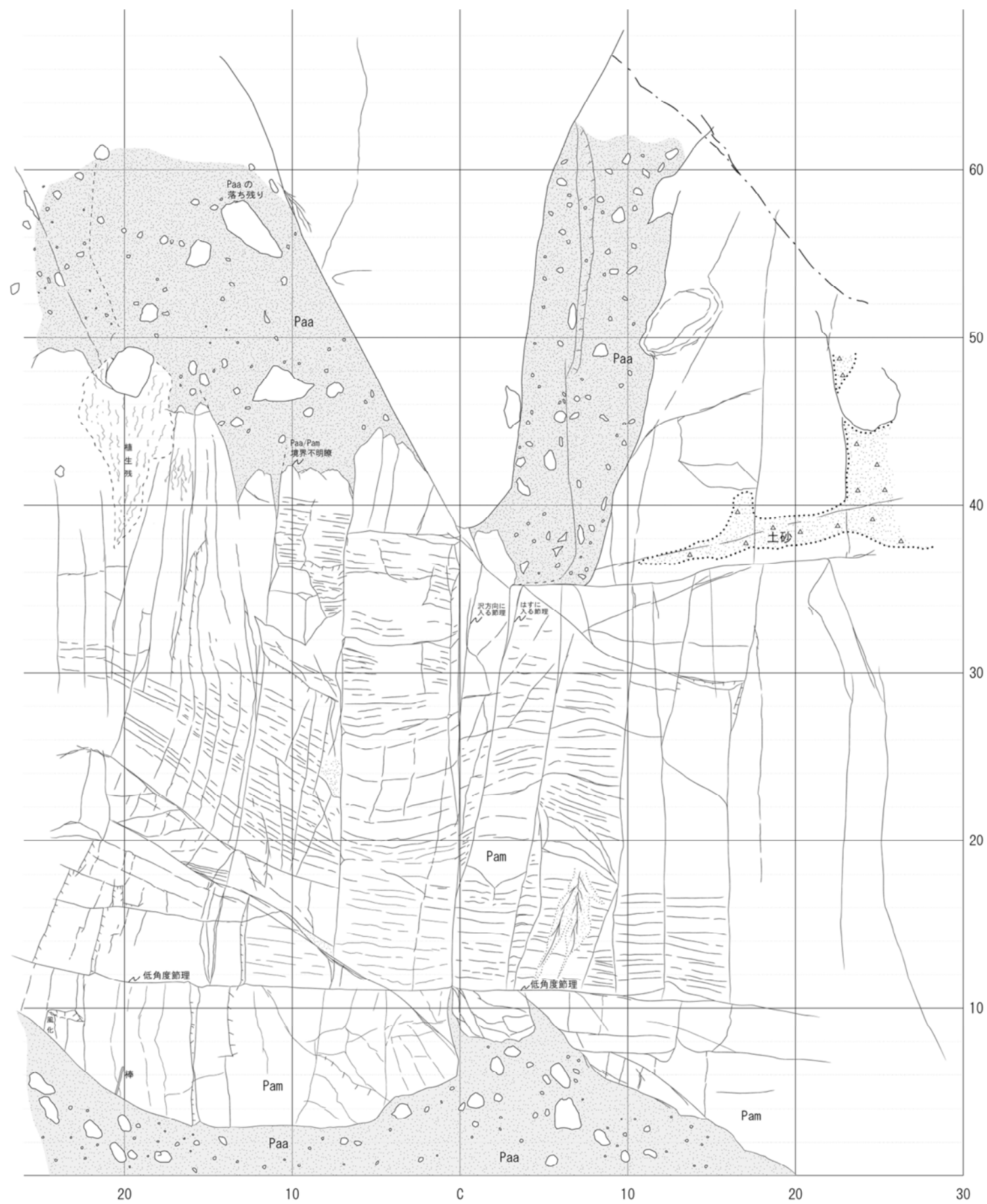
図-3.2.14 文献断層 25 延長部の岩盤露頭スケッチ
