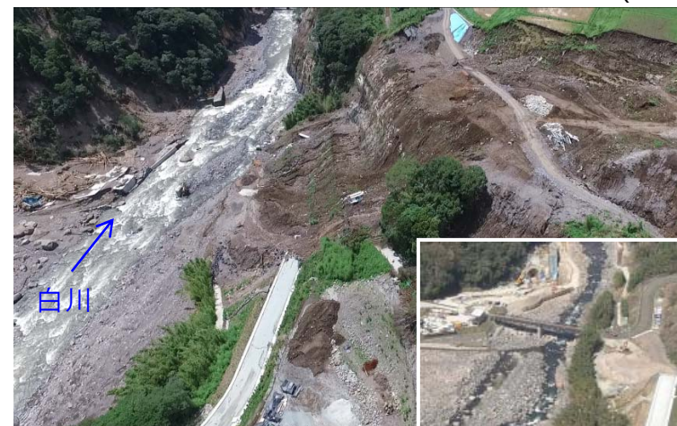
工事用道路埋没・仮橋落橋状況 (H28.7)
