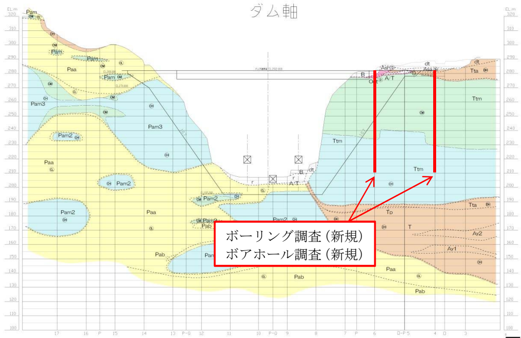
図-4.3.1 ボーリング調査断面図
