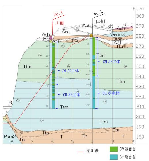
図-5.3.6 ボーリング横断図 (P測線)
