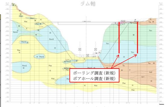
図-5.3.1 ボーリング調査断面図
