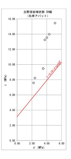
図-5.2.2 原位置せん断試験結果
