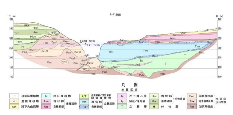
図-5.1.1 ダムサイト周辺の模式地質断面図
