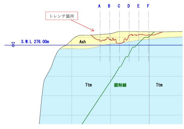
図-5.3.16 岩盤スケッチ箇所横断
