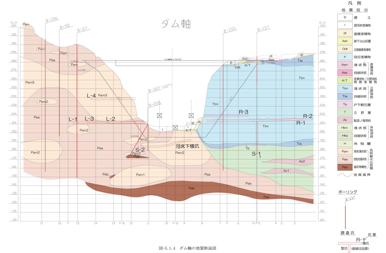
図-5.1.4 ダム軸の地質断面図
