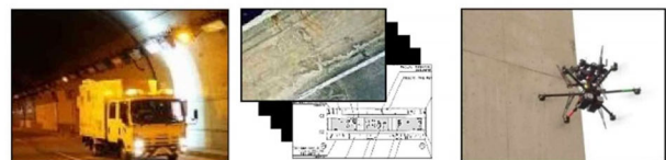
【ロボットによるインフラの点検画像の取得】
