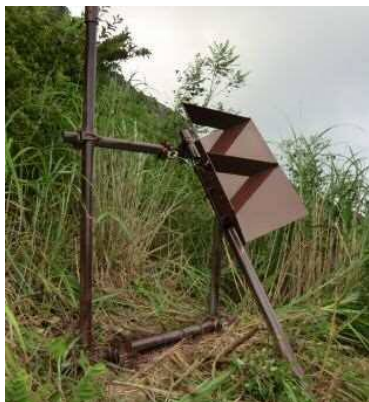
■ 図3 コーナーフレクタの設置状況
