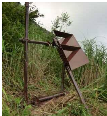
■ 図3 コーナリフレクタの設置状況
