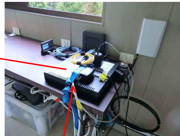
バンドでUPS、電源、ケーブル類を固定。
