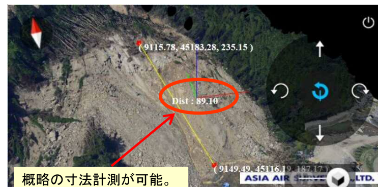
■ ⑥航空レーザ計測による崩壊確認事例(土砂量約4千m3)
