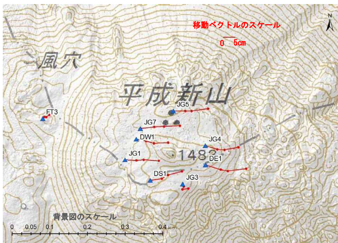
図.6 GNSS 観測による平成新山(溶岩ドーム)の移動ベクトル (H24. 10. 24～H27. 11. 12)
