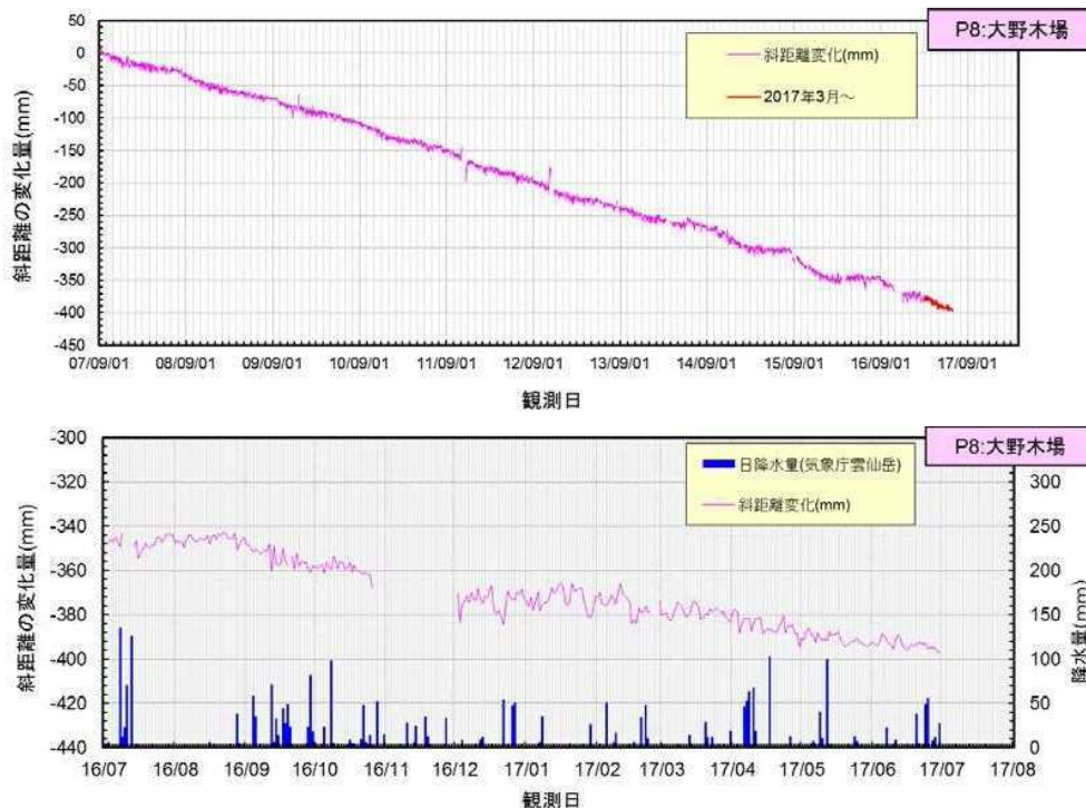
図.1 光波測距儀の観測結果の推移(1)
