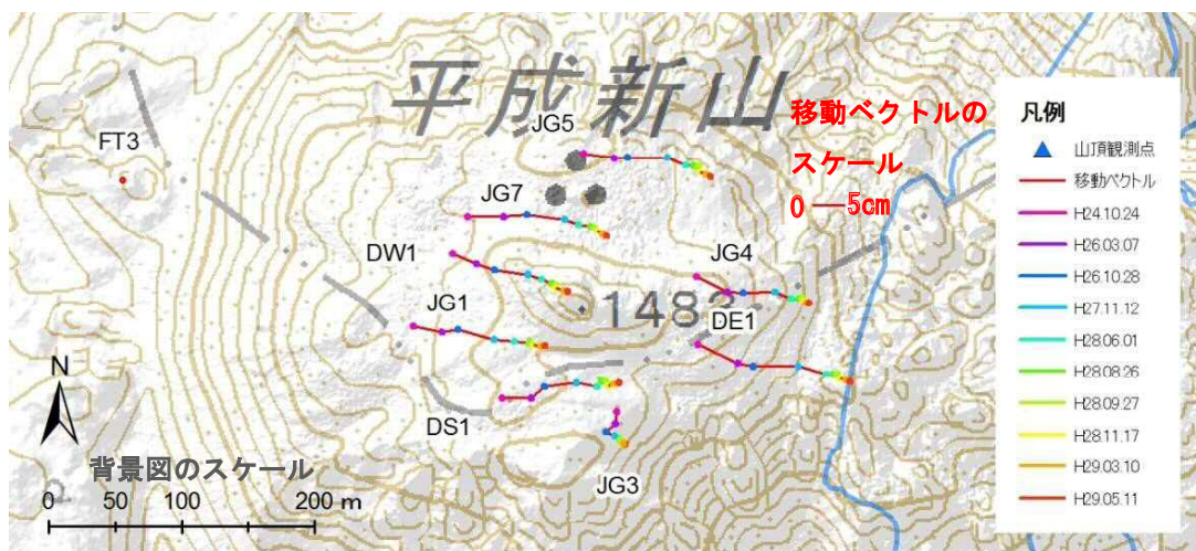
図.5 GNSS 観測による平成新山(溶岩ドーム)の移動ベクトル (H24.10.24～H28.11.17)
