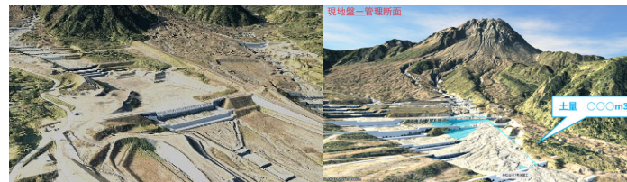
LPデータを加工、3次元化した赤松谷川流域のCIM
