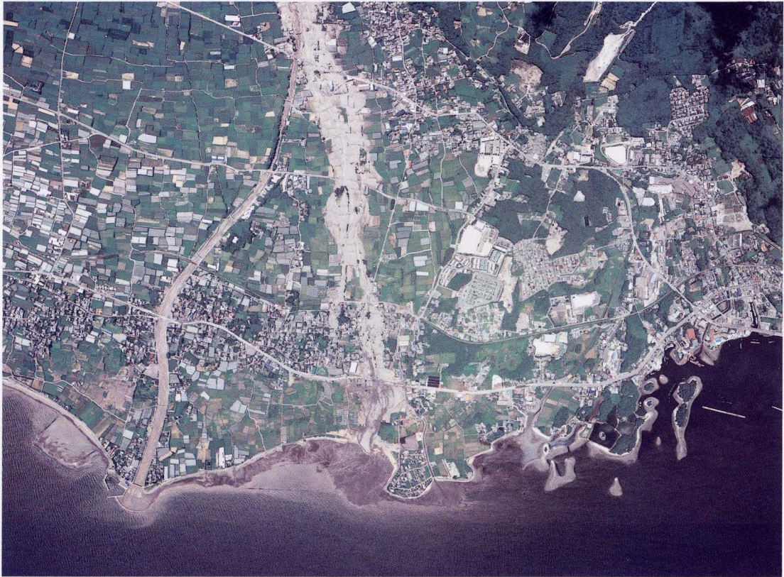
写真－10 6月30日に水無川流域で発生した土石流の氾濫・堆積状況 (左手が水無川本川下流部、中央が6月30日の土石流、 土石流は国道57号上流で左岸平地部に出て直進している。) [7月8日、アジア航測(株)撮影]
