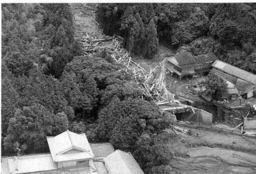
写真-7 流木による橋梁の閉塞と土石流の氾濫 (6月30日, 赤松谷川)
