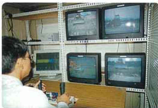
遠隔操作室の操作状況
