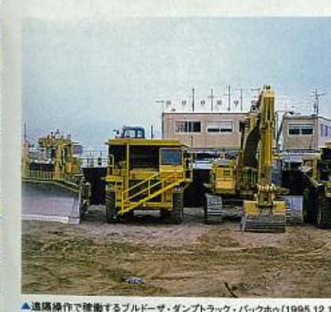
△遠隔操作で除雪するブルドーザ・ダンプトラック・バックホウ (1995.12.13)
