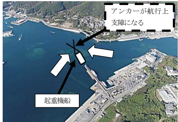
図-14 航行船舶の支障となる起重機船
