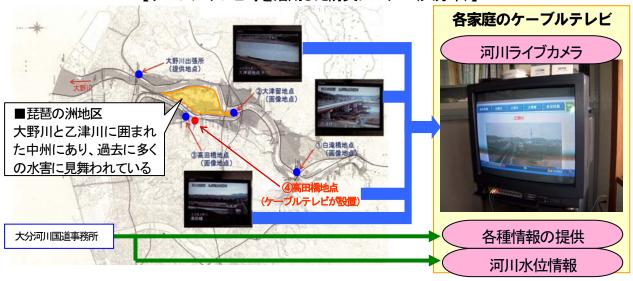
国土交通省の河川ライブカメラなどの情報をケーブルテレビで各家庭に提供するシステム。 チャンネルを動かすだけで河川画像や雨量・水位等の防災情報を簡単に入手することができる。
