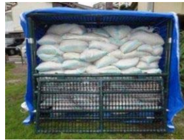
土のうステーション(土のう置き場)の事例(福岡市)
