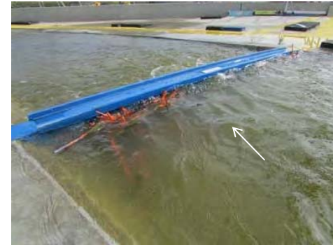
流木閉塞状況
