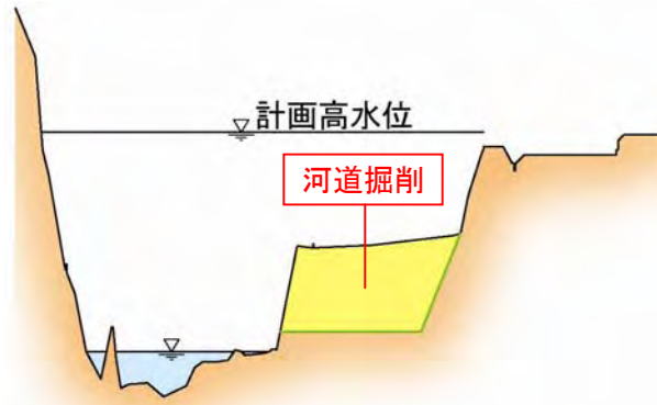
図 4. 2. 2 (3) 河道掘削のイメージ（山国川 26k600 付近）
