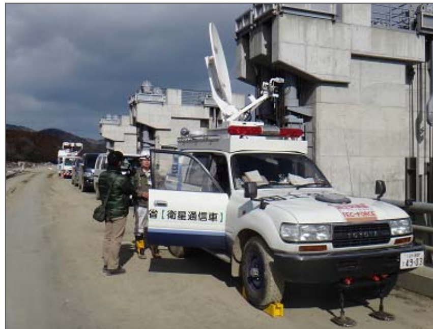
衛星通信車設営状況
