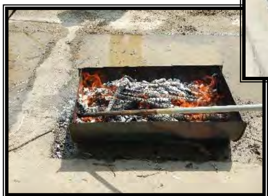
④ 炎が小さくなり炭化が完了した状態
