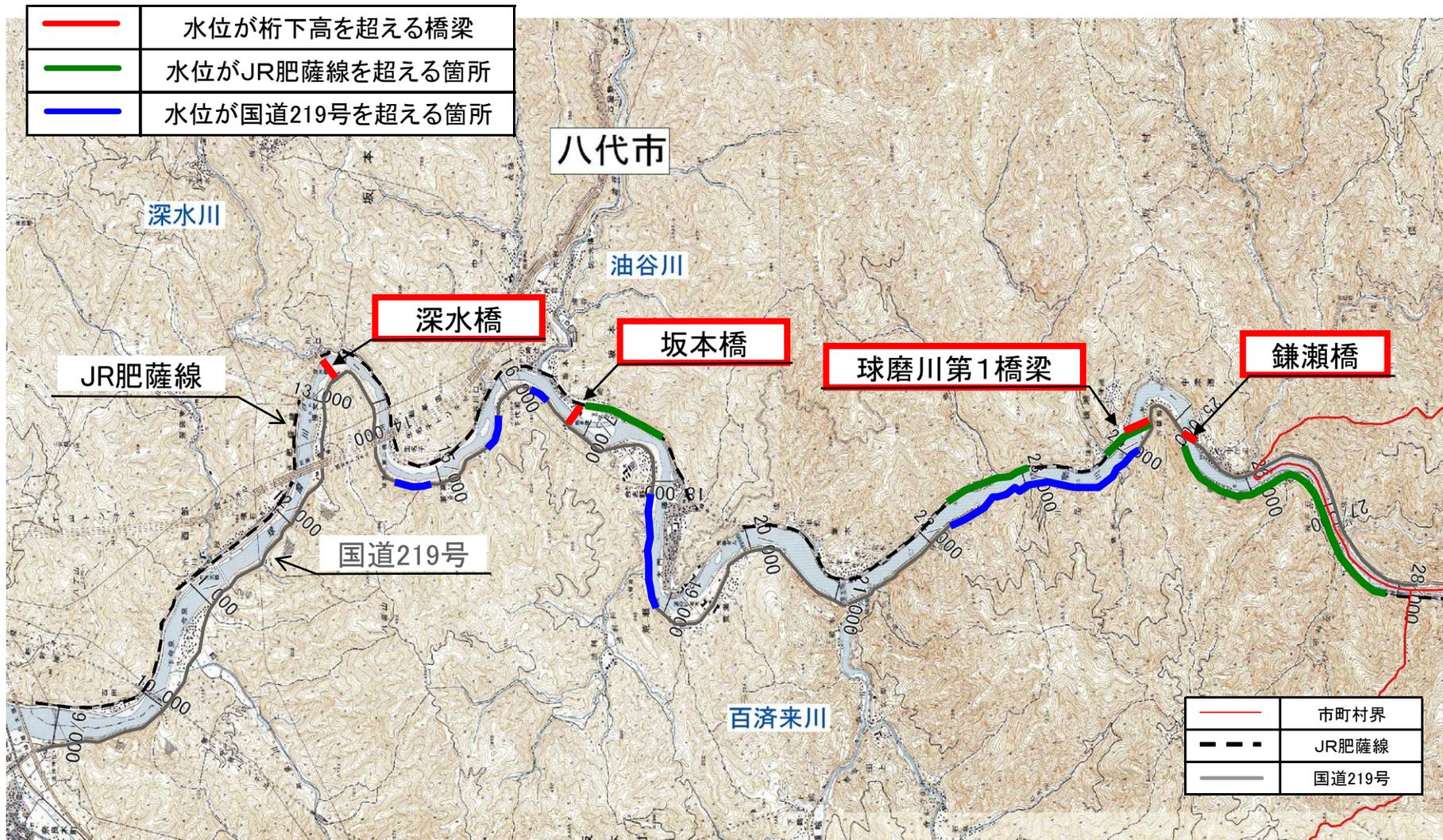
※シミュレーションにおいて橋梁の橋げたの影響は考慮していないため、堰上げにより計算水位以上に橋梁上流部の水位が上がることがあります。
