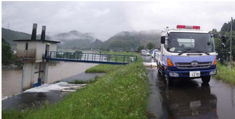
排水ポンプ車稼働状況
