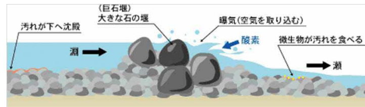
河川の自然浄化作用の概要図
