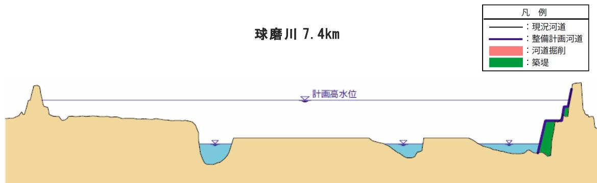
図 5.1 堤防整備横断図（7.4km 付近：八代市萩原地区付近）
