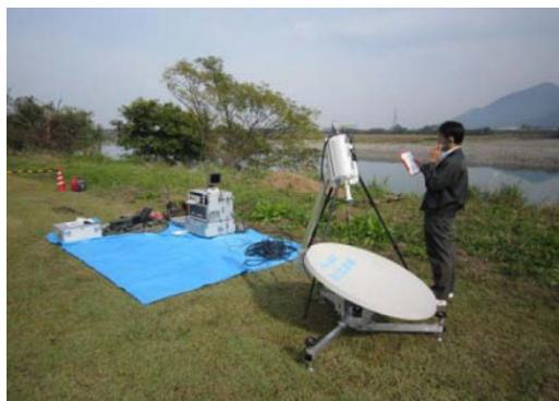
図 2.21 衛星小型画像伝送装置
