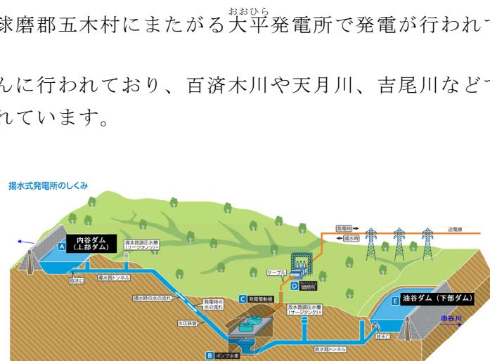
油谷ダム・内谷ダム揚水式発電のしくみ
